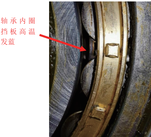
图 3 挡肩、角圈磨损严重
